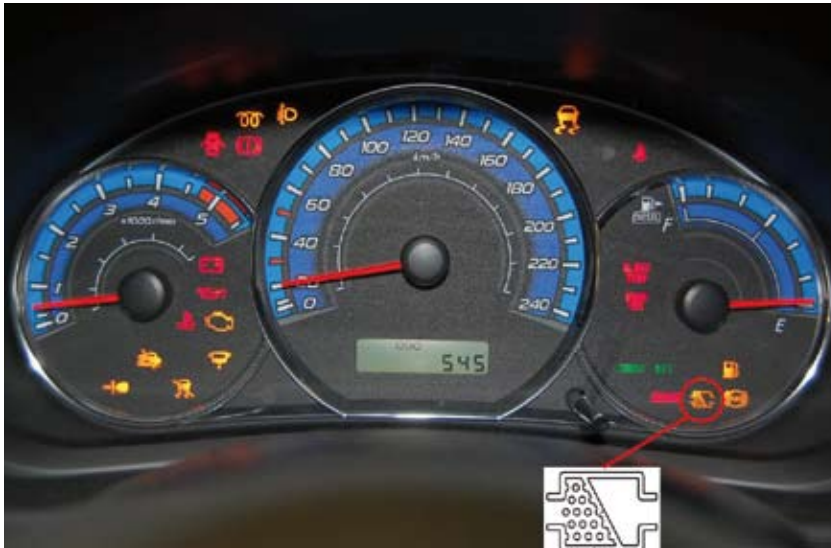
Kontrolka przypominająca o konieczności regeneracji filtra cząstek stałych na tablicy wskaźników
