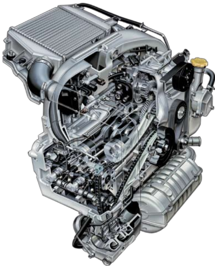
Silnik BOXER DIESEL z widocznym w dolnej części filtrem cząstek stałych
