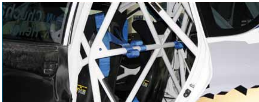
Wytrzymałość, a przede wszystkim sztywność na skręcanie i zginanie całego samochodu z profesjonalną klatką bierze się z prawidłowego projektu licznych zastrzałów i wzmocnień, tworzących zwykle zestaw trójkątnych struktur, odpowiednio przenoszących siły od zawieszenia auta na całą konstrukcję. Widać tu, że pasy bezpieczeństwa też mocowane są do klatki, resztą również zgodnie ze szczegółowymi przepisami technicznymi FIA.
