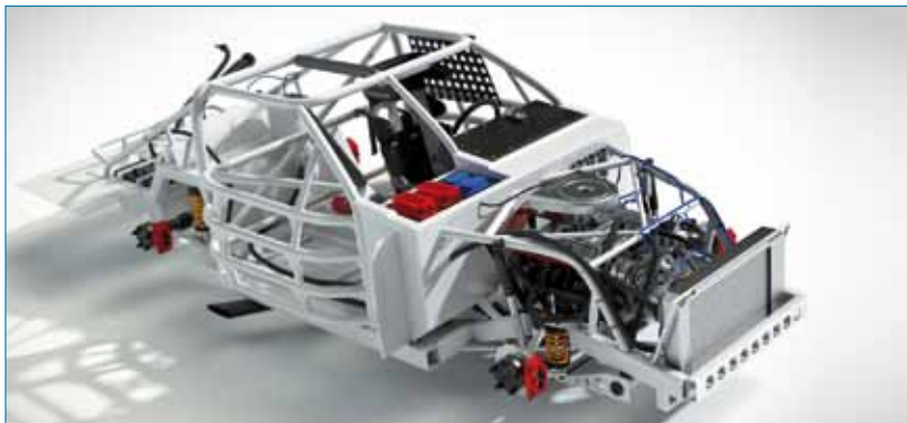
Współczesny samochód wyścigowy serii NASCAR pozbawiony poszyc nadwozia (studium nowej konstrukcji). Te pojazdy nadal nazywane są „stock car”, jednak widać, że z autami seryjnymi mają niewiele wspólnego, bo są przestrzennymi konstrukcjami rurowymi.
